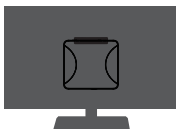
Befestigen Sie die Halterung mit Schrauben an der Rückseite des Displays
