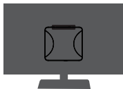
ネジでブラケットをディスプレイの背面に取り付けます。
