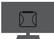
Закрепите кронштейн на задней панели монитора с помощью винтов
